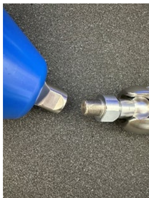
Separe el soporte de la almohadilla del brazo articulado
