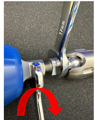
El soporte de la almohadilla se fija girándolo en el sentido de las agujas del reloj
