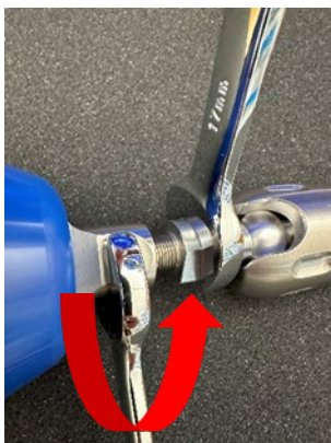
Suelte el soporte de la almohadilla girándolo en el sentido opuesto a las agujas del reloj
