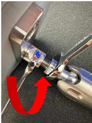
Afloje la almohadilla girándola en el sentido opuesto a las agujas del reloj
