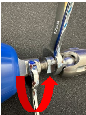
Rilasciare il supporto del cuscino ruotando in senso antiorario
