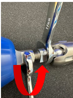
Lösen Sie die Pad-Halterung durch Drehen gegen den Uhrzeigersinn.
