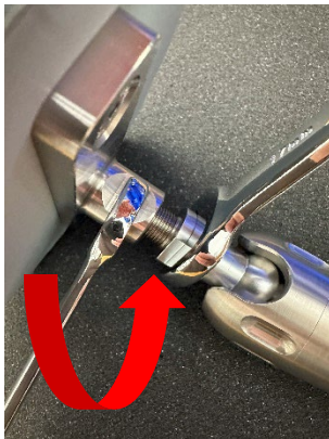
Lösen Sie das Pad durch Drehen gegen den Uhrzeigersinn.
