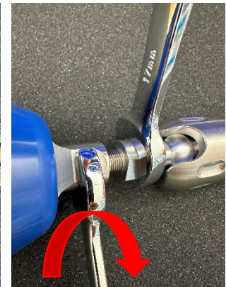
Befestigen Sie die Pad-Halterung durch Drehen im Uhrzeigersinn.
