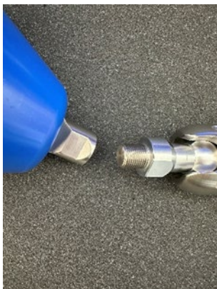
Séparer le support de coussin du bras articulé
