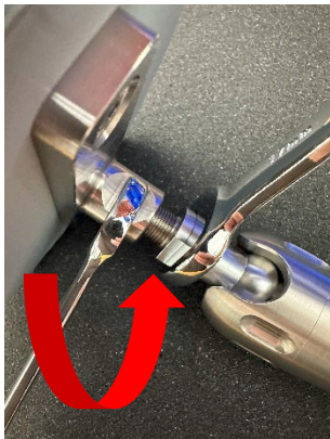
Desserrer le coussin en tournant dans le sens antihoraire
