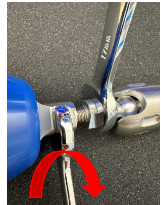
Tyynynpidike kiinnitetään kääntämällä sitä myötäpäivään
