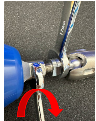
De kussenhouder wordt vastgezet door rechtsom te draaien
