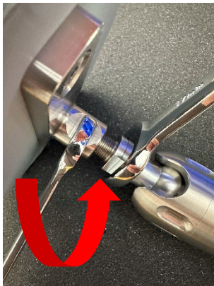
Maak het kussen los door linksom te draaien
